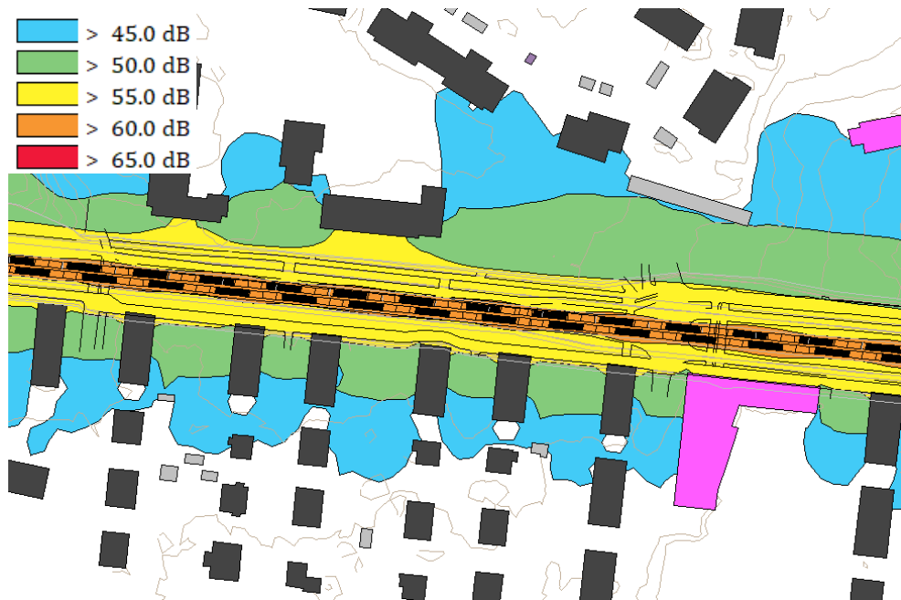
Kuva 4. Raitiovaunuliikenteen aiheuttamat melutasot Nuolialantien varrella. Melutasot ovat 8 dB pienemmät kuin yhteismelutarkastelussa (kuva 3).
